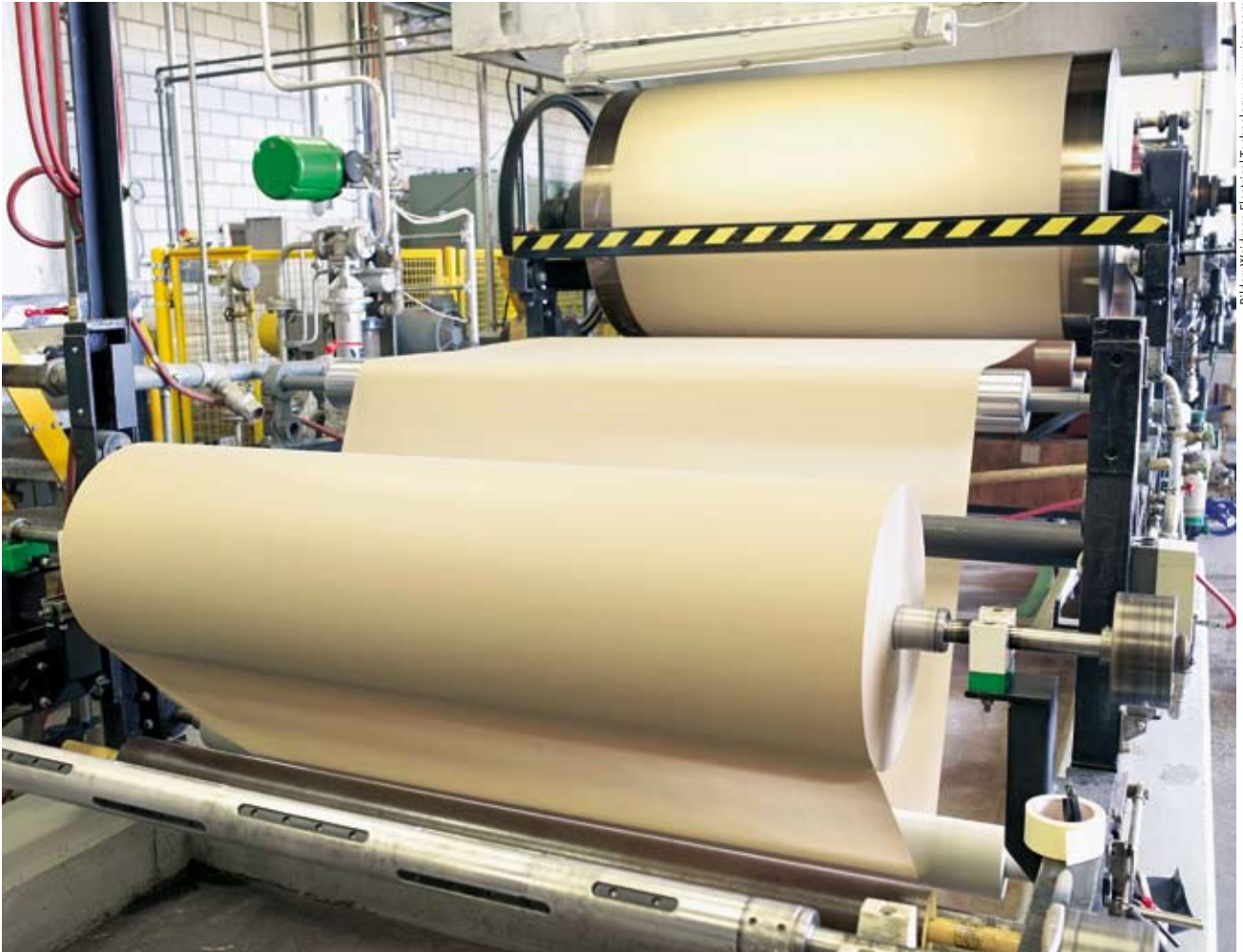
Produktion von Krepppapier: Zur Isolierung der elektrischen Leiter wird unter anderem Papier verwendet.
